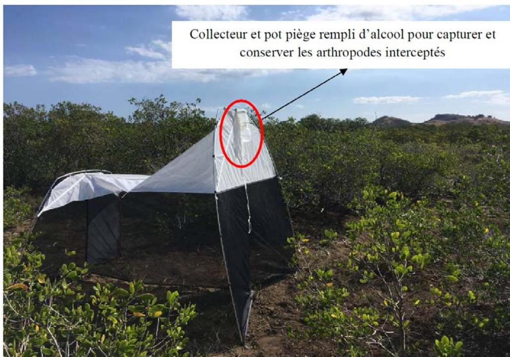
**Figure 5 : Piège d'interception utilisé (tente Malaise) pour échantillonner la faune résidente d'arthropodes terrestres, notamment insectes, dans les différents habitats d'intérêt identifiés (IAC-IRD, septembre 2017).**
