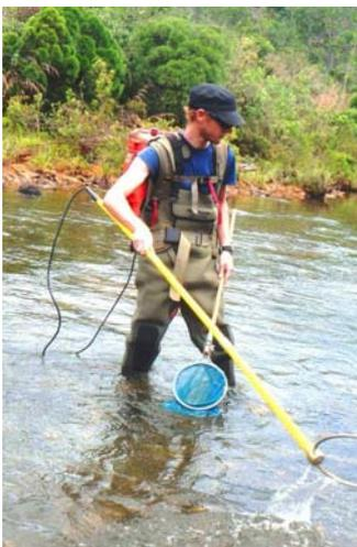
Figure 4 : Appareil de pêche électrique
